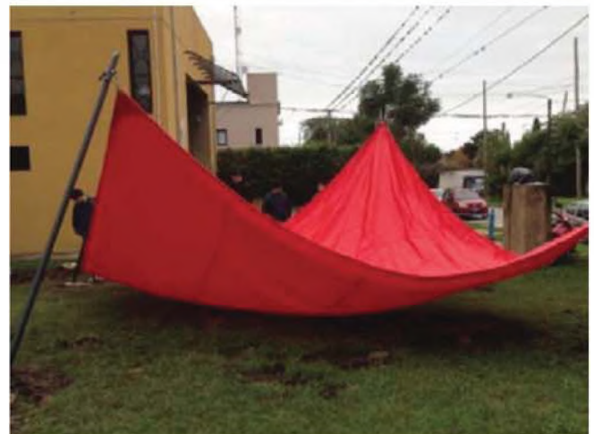
Figura 9: Inconveniente en la doble curvatura de la membrana. Fuente: elaboración propia
