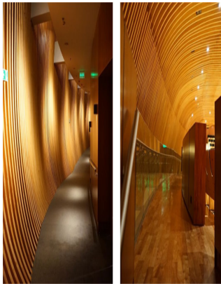
Figura 7 (izquierda). Indica los pasillos de circulación que actúan como cámara de reverberación. Fuente Basso (2021).
