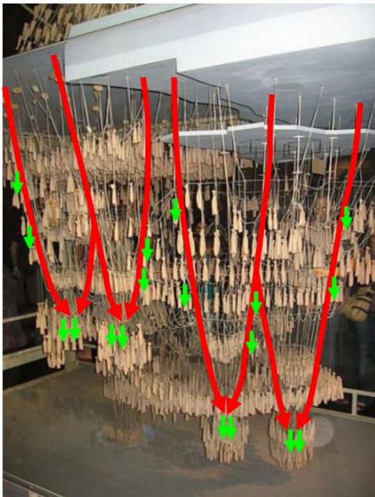
Fig. 5 – Líneas de tensión definidas sobre la maqueta de estudio. Fuente: Producción propia Una vez definidas las líneas de tensión, giraba 180° la imagen (Fig. 6).
