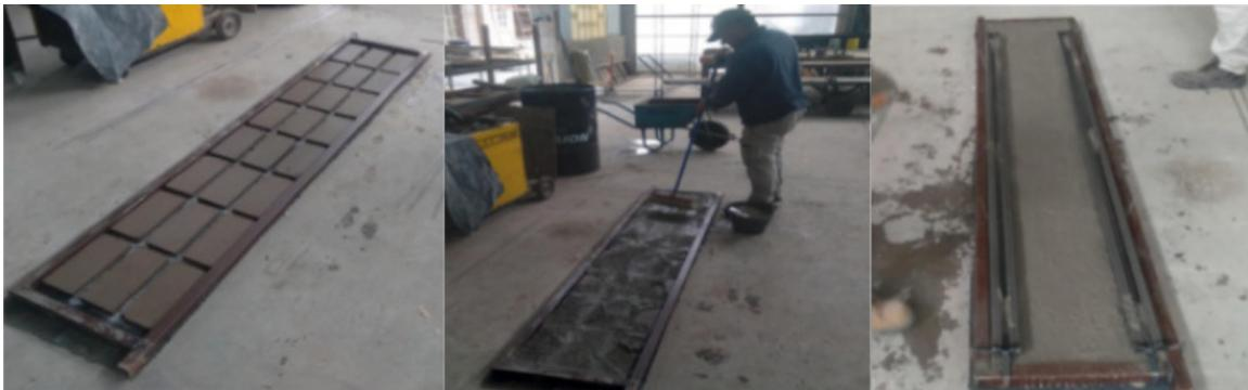
Figura 3. Secuencia de fabricación de la placa BENO.
