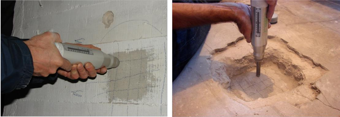
Figura 1. Esclerómetro.
