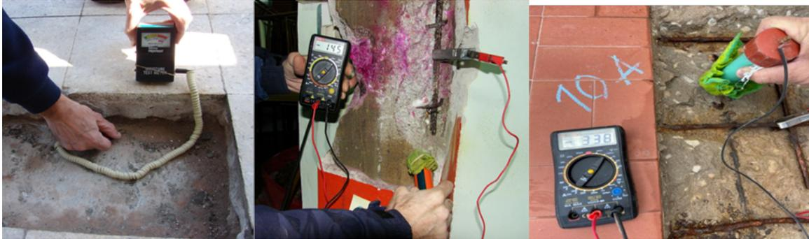
Figura 6. A la izquierda: Medición de tenores de humedad. Al centro: aplicación de fenolftaleína. Al centro y a la derecha: medición de potenciales de corrosión.
