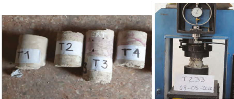
Figura 4. A la izquierda: Probeta testigo de hormigón. A la derecha: Prensa para ensayo a la compresión.
