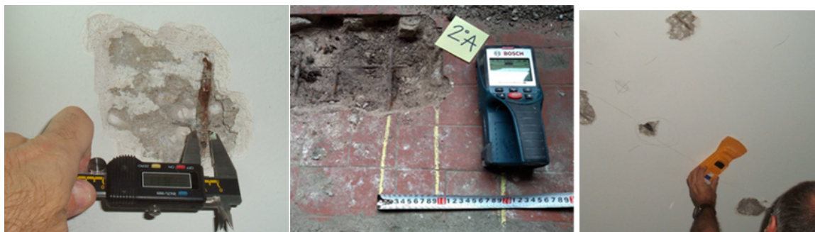
Figura 5. A la izquierda Calibre. En el centro y a la derecha: Detector de armaduras, pacómetro.
