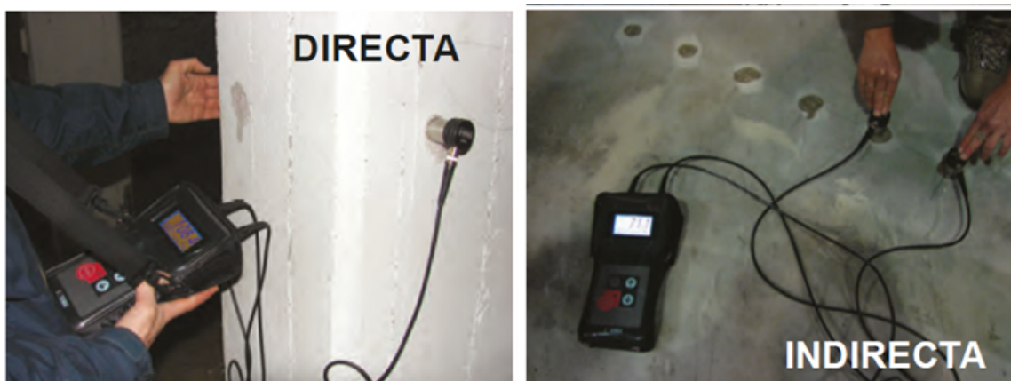
Figura 2. Medición de la velocidad de propagación de un impulso ultrasónico.
