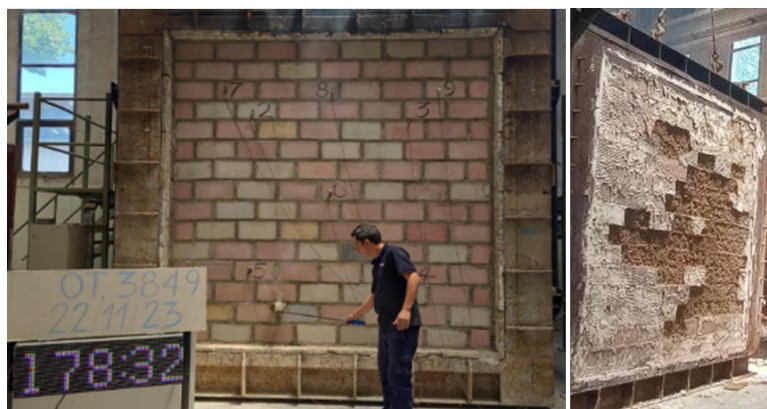
Figura 5. Muro ensayado, vista externa y de cara expuesta al fuego .
