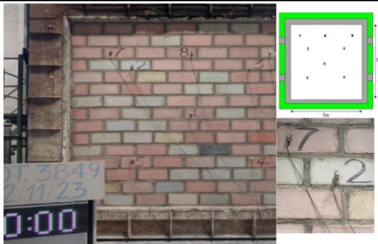
Figura 4. Muro ensayado, ubicación de termopares y esquema de su colocación.
