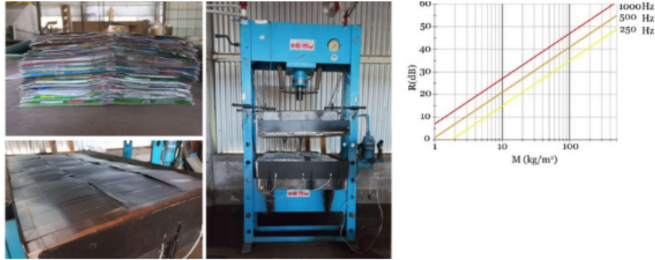
Figura 1. (a) Envases de Tetrabrik distribuidos en prensa de platos calientes. (b) Ley de Masa. Índice de reducción acústica R en función de la masa por unidad de superficie M.
