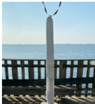
Figura 4 Imagen del sistema de generación basado en el concepto VIV Ordoñez y Reyes Duke, 2021
