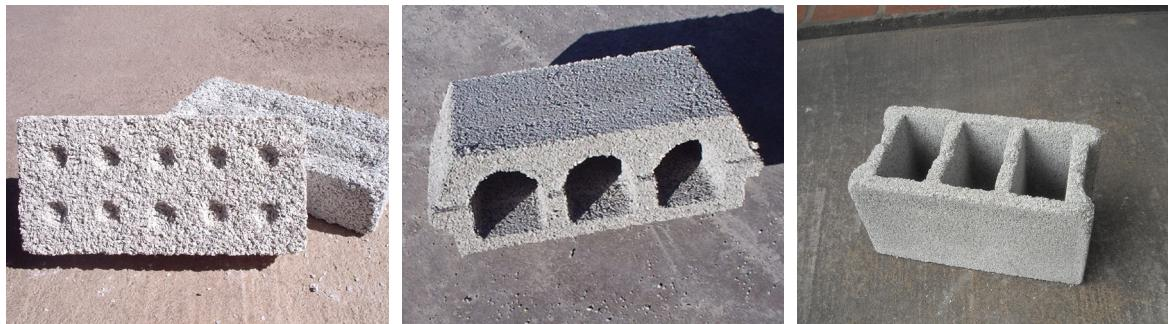
Figura 1. Componentes fabricados con PET reciclado. Fuente: Archivo fotográfico del instituto.
