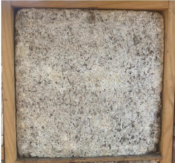
**Figura 4.** Placa de residuos celulósicos ligados con micelio.
