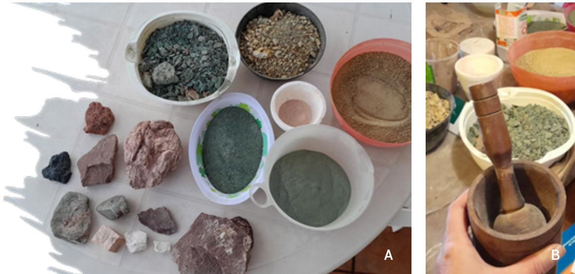
Figura 3. a): Tierras tamizadas con distintas granulometrías. 3.b) Mortero utilizado. Fuente: fotografías de Giovinò, 2023.
