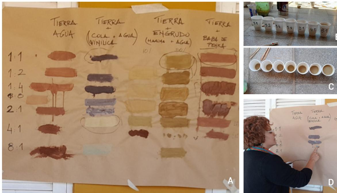
**Figura 4.** a. b. c.: Resultados de ensayo de mezclas con distintas tierras, proporciones y aditivos. Fuente: a, b y c. Fotografías de la autora. d) Fotografía Arq. Emilia Erostarbe (miembro Red Protierra y FAUD).
