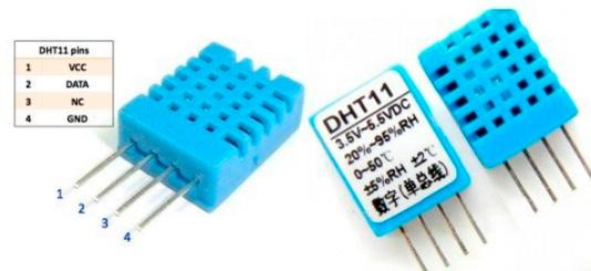
*Figura 3: Termohigrómetro DHT11*
