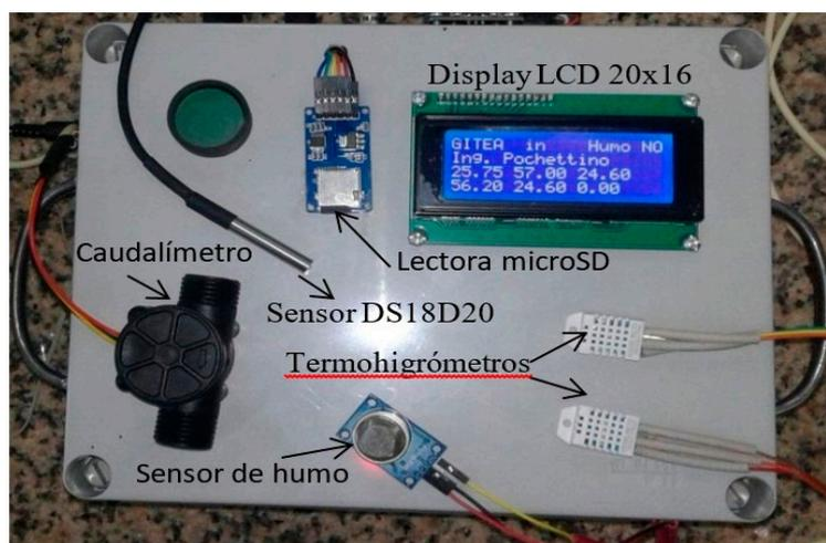
Figura 9: Datalogger utilizando arduino mega 2560
