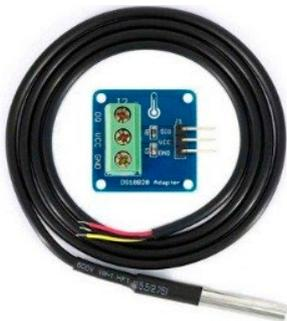
*Figura 4: Sensor digital de temperatura*
