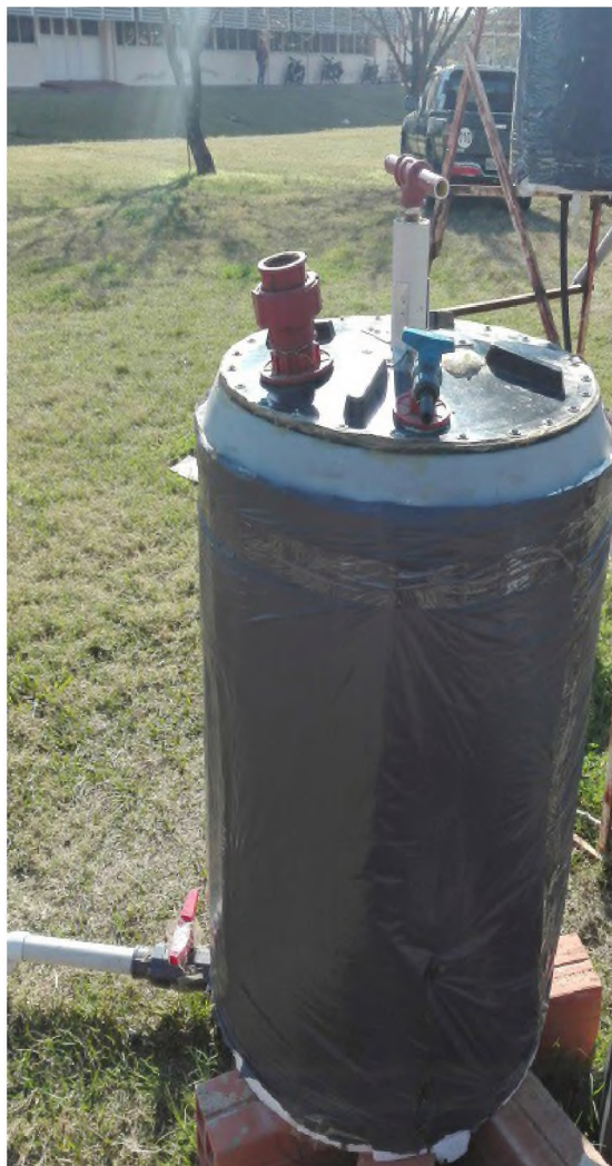
Figura 2: Sistema experimental de biodigestión de flujo semicontinuo
