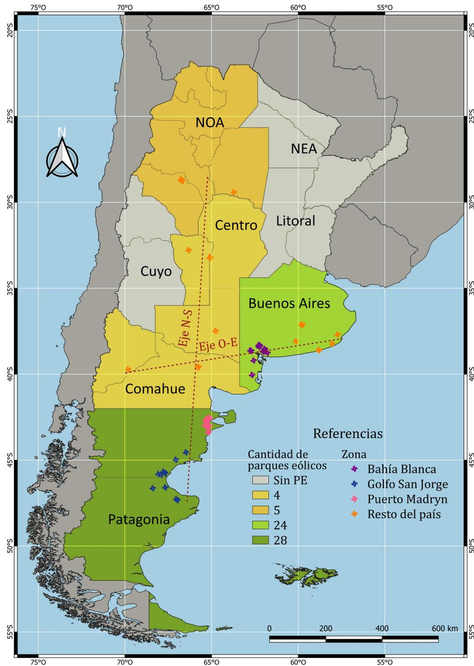
Figura 3. Zonificación de la generación eólica de alta potencia y cantidad de parques eólicos según región eléctrica. Argentina, 2023.
